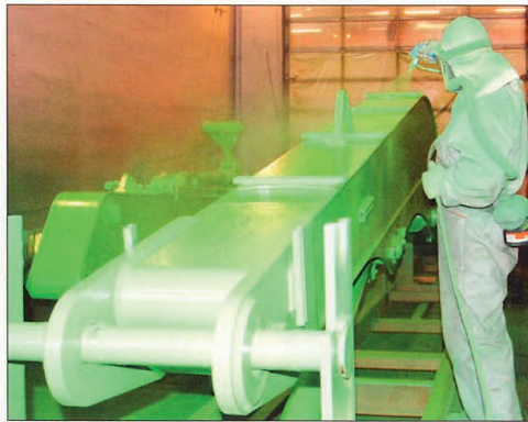
Herzstück der neuen Lackiertechnik ist die 2K-Airless-Farbspritzanlage. Quelle(zwei Fotos): Redaktion
