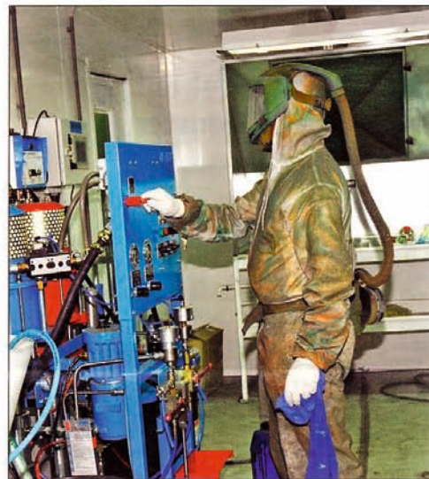
Der Einsatz der „Fleximix II“ reduziert den Materialverbrauch und beschleunigt die Abläufe bei Conver deutlich. Quelle: Wiwa
