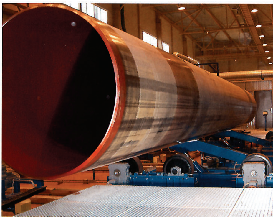
Auf Nummer sicher: Die Öl- und Gaspipelinerohre mit Wandstärken von bis zu 20 Millimetern erhalten innen eine reibungsarme und vor Korrosion schützende Beschichtung
