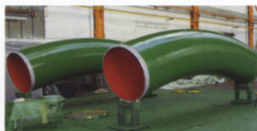
Die fertig beschichteten Rohrbögen
