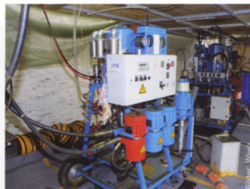
Zwei solcher 2K-Beschichtungsanlagen sind bei dem Dienstleister im Einsatz
