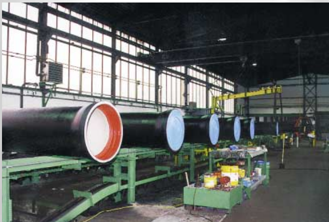
Rohraußen- und -innenbeschichtung
