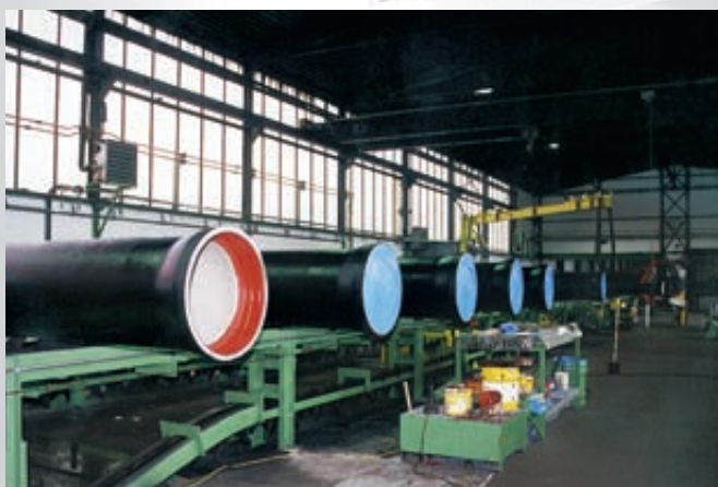
Revêtement intérieur et extérieur de tuyaux
