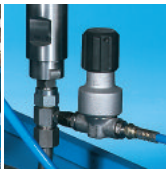
Régulateur de retour pour des températures constantes avec la méthode de pulvérisation à chaud et son système de circulation.
