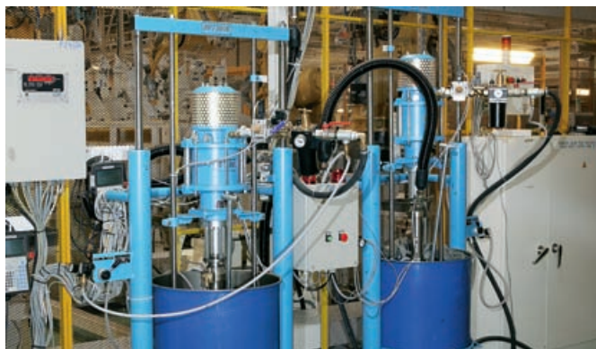
Système double à mécanisme by-pass automatique
