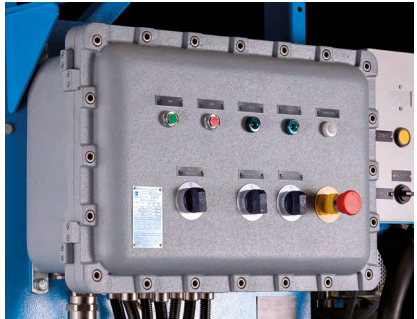
Caja de control presurizada
