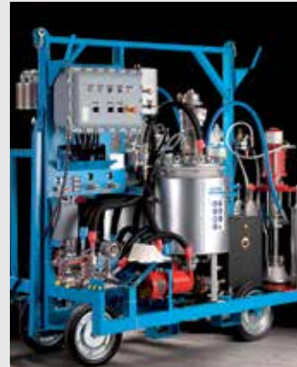
WIWA DUOMIX 333 PFP ATEX, für Brandschutzmaterialien
