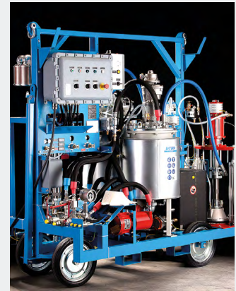
WIWA DUOMIX 333 PFP ATEX, für Brandschutzmaterialien
