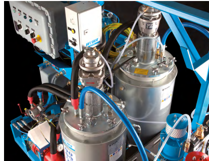
DUOMIX 333PFP -Zone 1- pneumatisches Rührwerk
