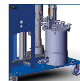
Alimentación a través de tanque de presión
