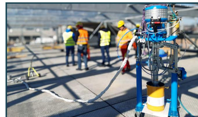
Une version plus petite du **WIWA DOSYS B** a été utilisée pour remplir les joints d'un parking.
