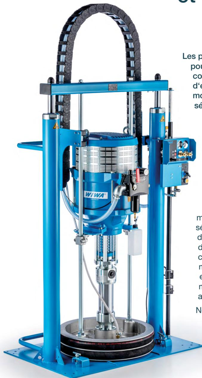
Les pompes à extrusion **WIWA VULKAN GX** pour le transport, le dosage et l'application de colles, de matériaux isolants et de matériaux d'étanchéité misent désormais sur le nouveau moteur pneumatique WIWA GX. Celui-ci séduit par un boîtier entièrement métallique, une répartition optimisée de l'air pendant le fonctionnement afin de minimiser le givrage en cas de fonctionnement continu et une réduction du bruit.
