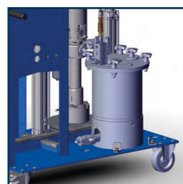
Alimentação via tanque de pressão
