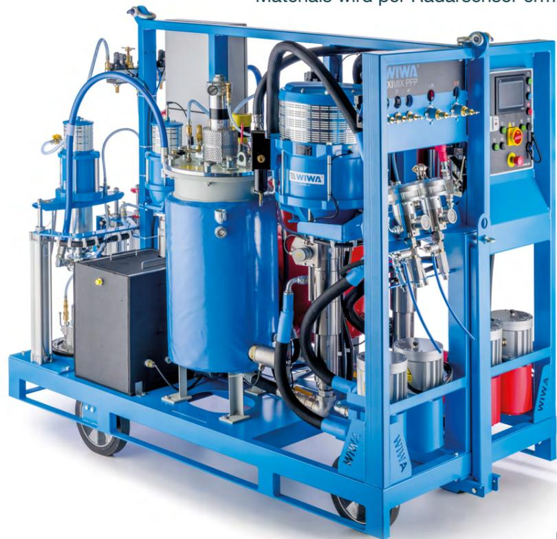
Die Hochleistungsreihe kommt standardmäßig auf einem Staplergestell mit Schlauchhalter und Kranösen und ist dadurch erstaunlich mobil und nahezu grenzenlos einsetzbar. Für noch mehr Flexibilität bieten wir auch eine Erweiterung zum fahrbaren Gestell an.
