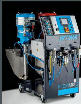
WIWA FLEXIMIX 2, equipo electrónico de aspersión de componente plural
