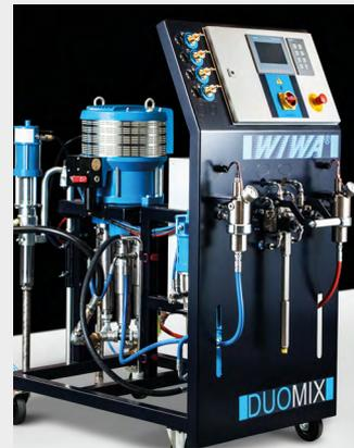
WIWA DUOMIX, pneumatische Mehrkomponenten-Spritzanlagen
