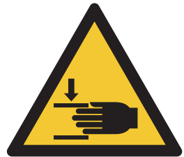
Fig. 1: Advertencia de peligro de aplastamiento
