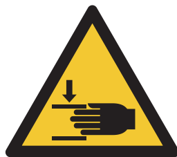
Fig. 1: Aviso de perigo de esmagamento
